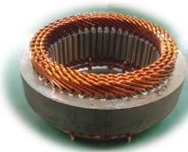
(ステータ: Φ215x50) 試作モータ外観
